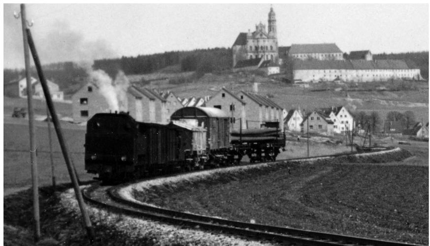
Anfangs der 1950er-Jahre ist Lok 5 bei Neresheim mit einem Güterzug in Richtung Aalen unterwegs. Der Zug besteht aus Stückgutwagen, Pufferwagen und aufgebockten Wagen: einem Kalkdeckelwagen, einem gedeckten Güterwagen und zwei mit langen Baumstämmen beladenen Langholzwagen. Anhand des Klosters und alter Karten kann der Standort dieser Aufnahme festgestellt werden: der Fotograf stand am heutigen Ortseingang von Neresheim oberhalb des Härtsfeld-Centers.
